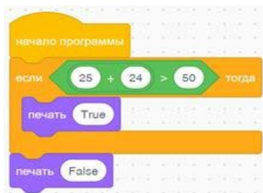
Рис. 22. Пример использования условного блока
