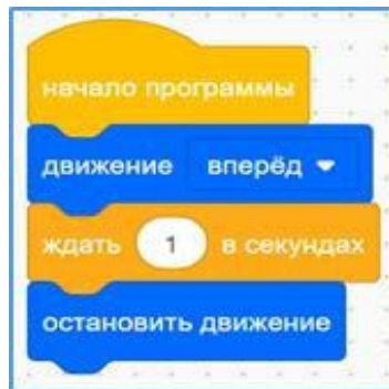
Рис. 18. Пример программы с использованием блока Ожидания
