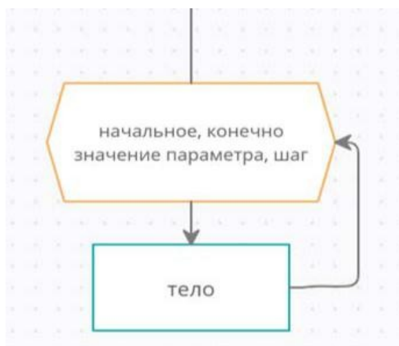
Рис. 58. Блок-схема цикла с параметром
