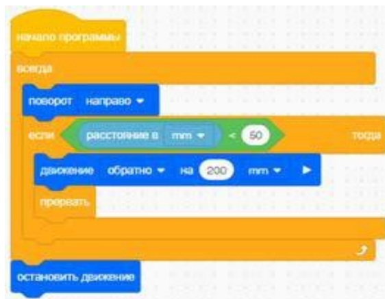
Рис. 30. Программа для демонстрации работы цикла прерывания
