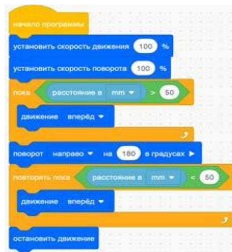
Рис. 26. Отличия циклов в VEX VR
