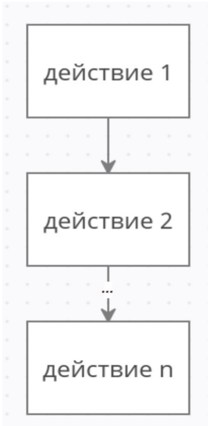
Рис. 107.. Блок-схема линейного алгоритма
